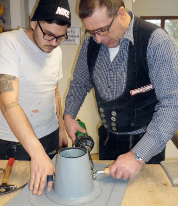
Azem Shabani beim Schweißen eines Einlauftrichters.
