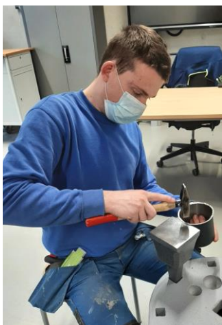
Abbildung 14: Erstellung eines Bechers aus Aluminium- und verzinkten Stahlblech
